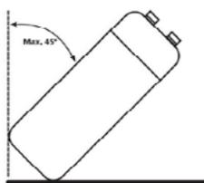
Inclinación máxima para el transporte manual durante la instalación.
