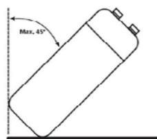
Inclinaison maximale pour le transport manuel lors de l'installation.
