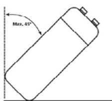
Inclinação máxima para transporte manual durante a instalação.
